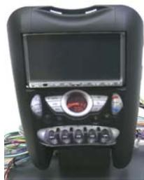
しかし、どうにか取り付けられるようにしたいと開発に着手しました。一番の苦勞はいかにして後付けのカーオーディオ、カーナビゲーションを付けるスペースを確保するかでした。そのために純正から交換しても違和感の無い大型パネルを開発、また純正のオーディオを移設させるアタッチメント(GE-BM201)を開発しました。苦心の末開発に成功し、視界を妨げない位置にカーナビゲーションを付けられるキットとして今では多くのBMWミニオーナーさんに重宝して頂いております。
