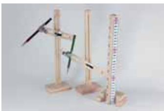
卓上スケールは、ベース中央部側面に脱着できる異形支柱を垂直に備えて、左右の二面に異なる目盛りを有し、机や作業台などの上に置き、仏像彫刻などの指針を当て、当てた指針を制作している作品に書き添えることが簡単にできます。現状は、物差しを右手で持って、机や作業台の上で垂直に立て、左手に持つトースカンの指針を近づけると物差しが前後に振れて、測りたい寸法の目盛りに当てることが難しく、その解決したのは、木製の卓上スケールであり、移動しても異形支柱は前後に振れることがありません。
