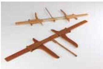
木製ノギスは、仏像彫刻など、立体構造物の中心線から左右の測定箇所幅と高さ(深さ)を測定し検査を行う測定器で、木製ノギスの中央にある指針先端を測定する中心線に当て、左右の測定箇所に左右の測定部先端を当て、測定部側面と交差する本体の左右にある目盛りを確認することで中心線と測定箇所の高さを求めることができます。測定する箇所に合わせて測定部の長さを合わせるには、指針装着部の挿入口を変えることで長さの違う測定部を求めることができます。
